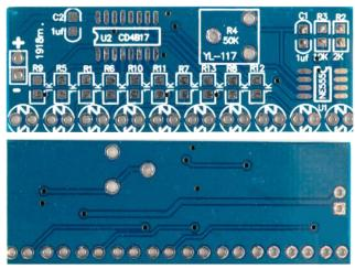
2) **10x** 1kΩ **SMD resistors** – R1, R5, R6, R7, R8, R9, R10, R11, R12, R13
