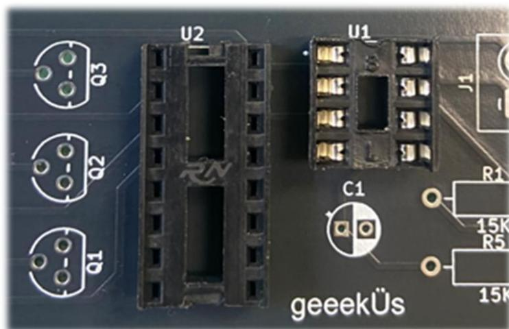
Placez ensuite les transistors. Ils doivent être placés sur la carte comme indiqué sur l'image ci-dessous, le côté plat de chacun correspondant au côté plat de leurs sérigraphies. Les transistors sont identifiés sur le PCB par la désignation commençant avec la lettre Q#.
