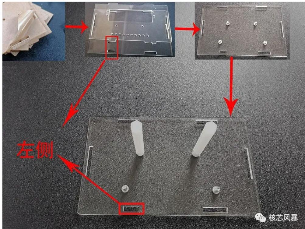
**2.先确认底部和前面的外壳安装方向，开口短的一面在左侧，再从底部插入螺丝并拧上尼龙柱。**
