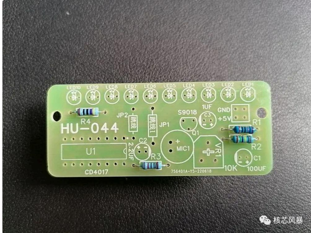
1.对照丝印插入对应的电阻并焊接。
