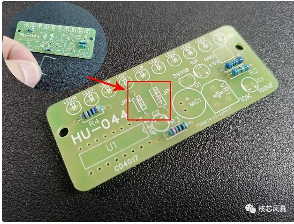
2.用剪下来的引脚折弯成合适大小做成跳线，插入跳线JP1和JP2并焊接。
