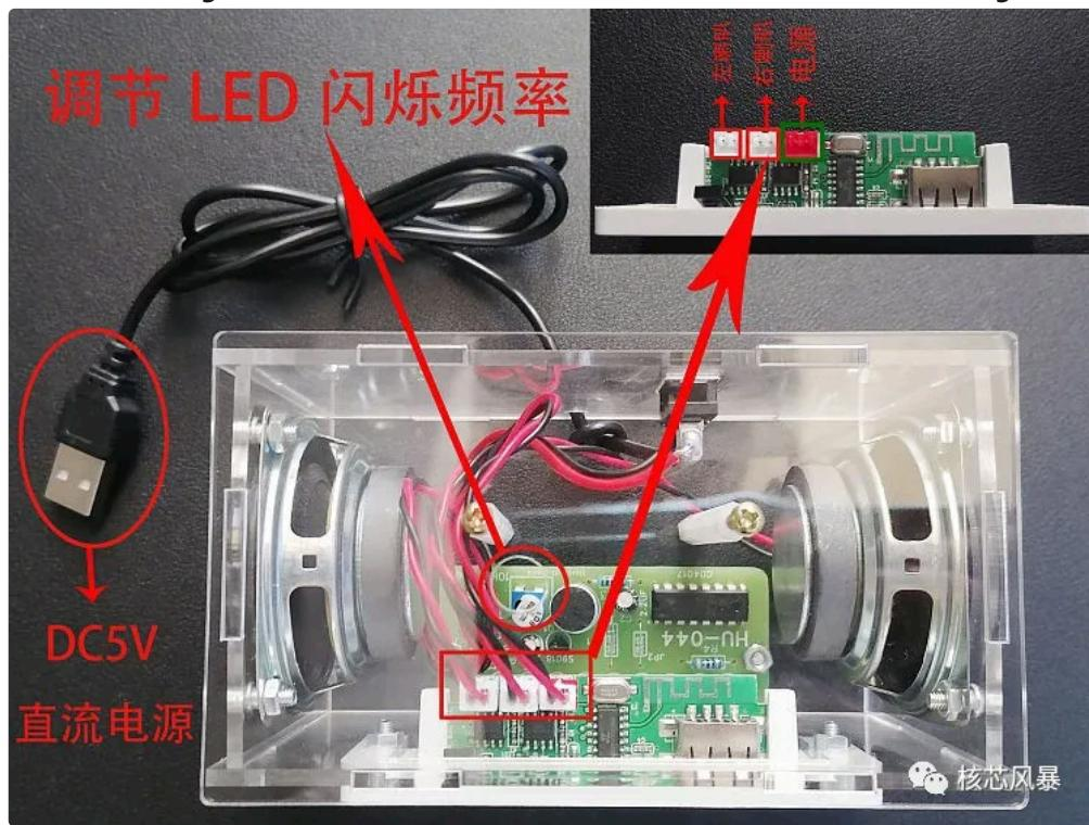
5.连接上对应的端子线，盖上外壳，用最长螺丝固定！然后开机测试，完成安装！
