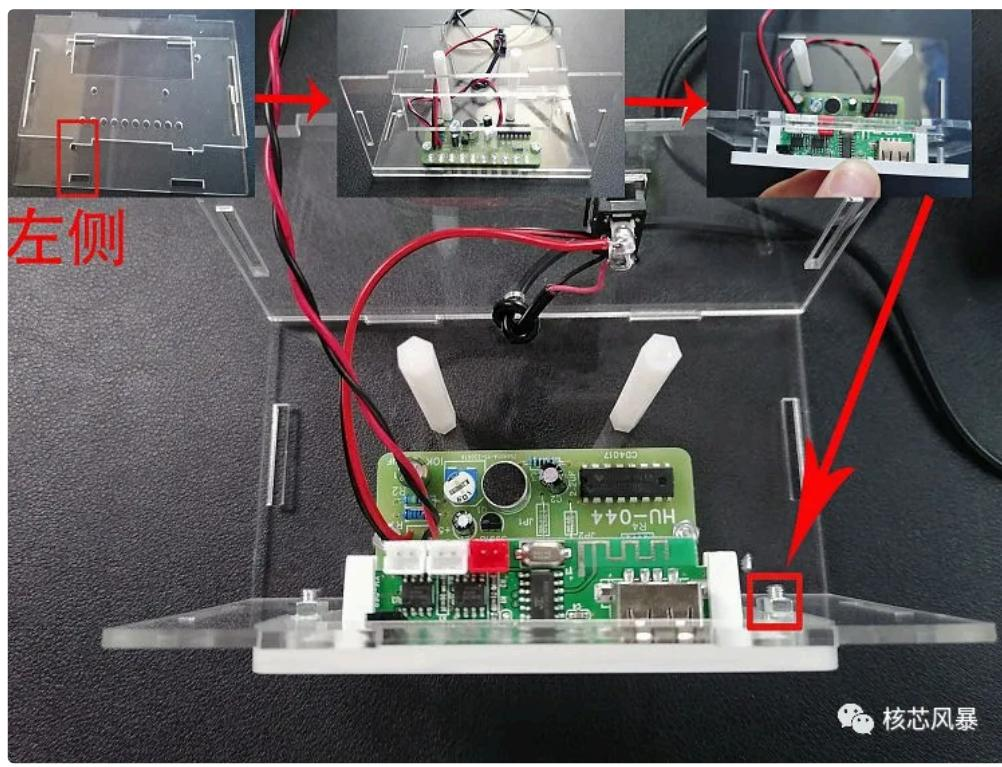
**3.因为焊接有差异，最好PCB和前面外壳同时安装，螺丝插入蓝牙解码板，用螺母固定到外壳上。**
