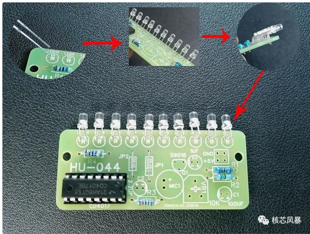
4.插入LED（长正极）不要插到底，焊接后折弯90度。
