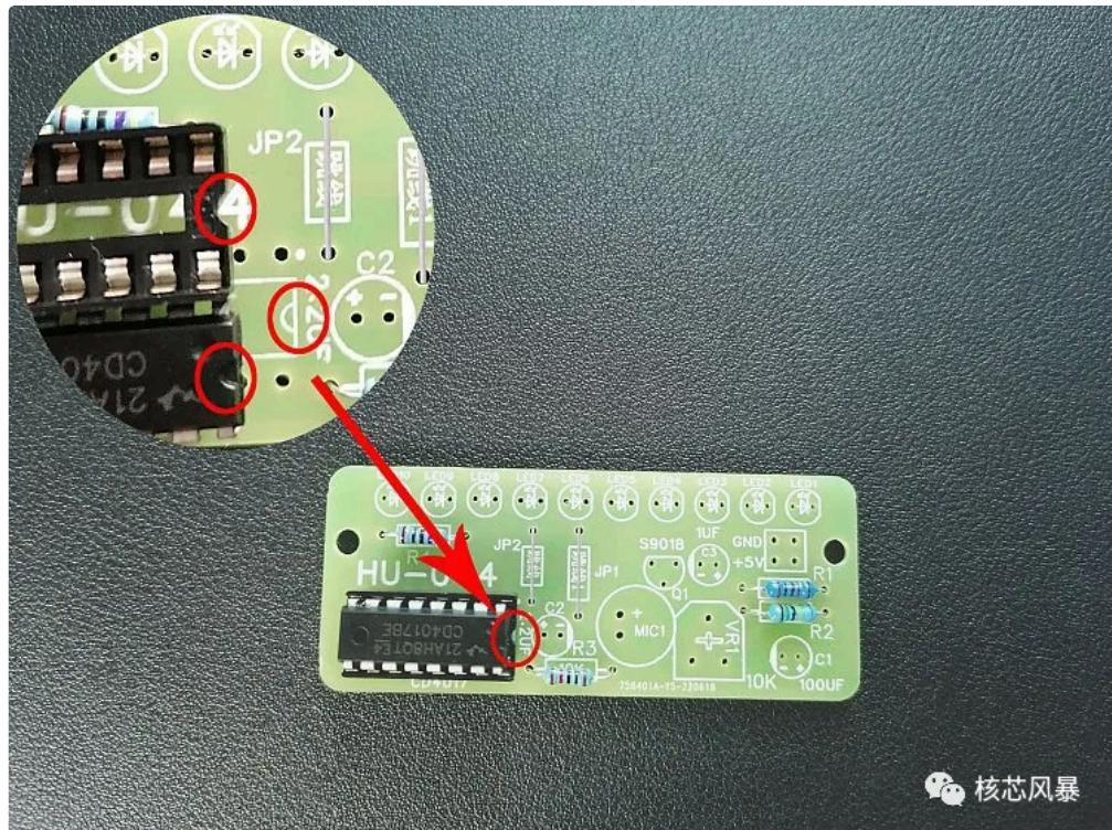
3.焊接上IC插座，安装CD4017单片机（U形缺口与丝印图案对应）。
