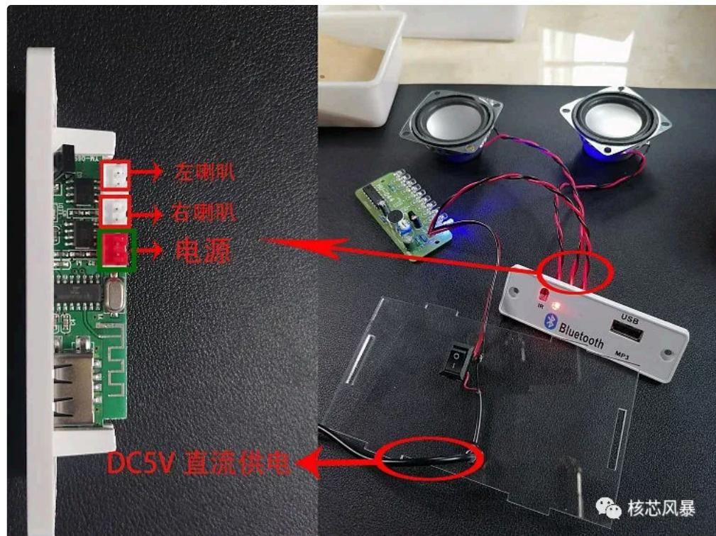
9.将PCB和喇叭连接到蓝牙解码板上，电源线连接5V直流电源，开机测试功能正常后再安装外壳。
