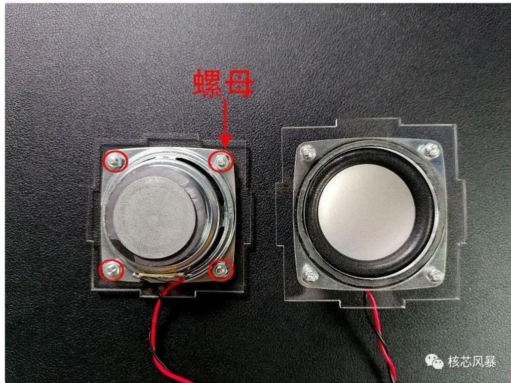
1.撕掉所有外壳的保护膜，先将两个喇叭用螺丝固定在外壳上。然后用螺母从里面固定。
