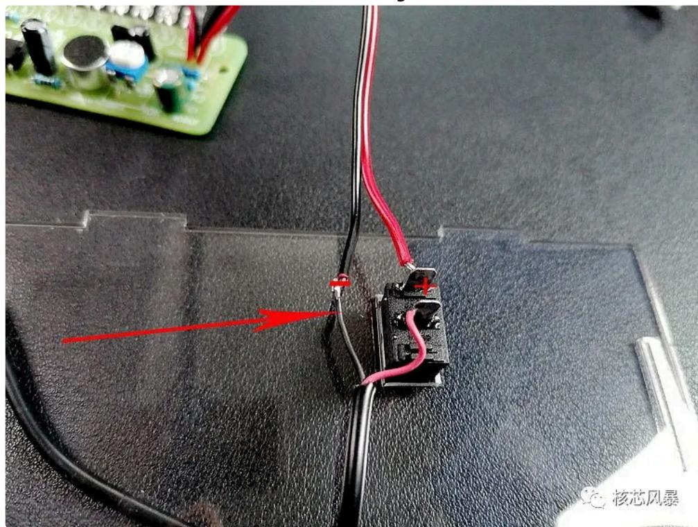
8.将红黑并线与电源线的负极焊接到一起，正极分别焊接在船形开关两端。
