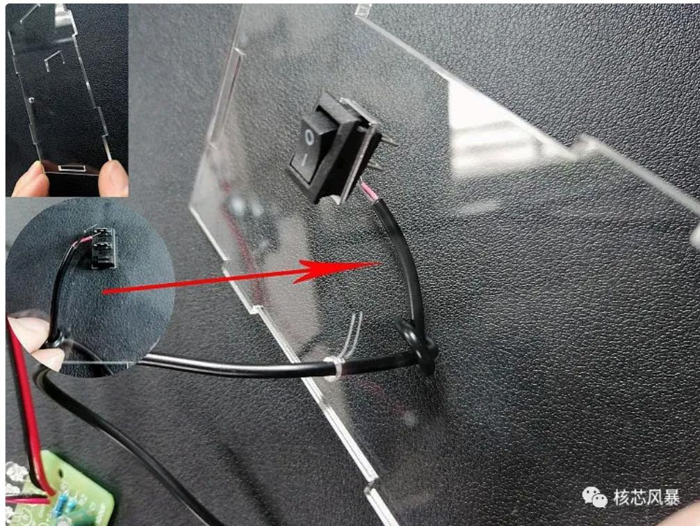
7.后面一片外壳撕掉保护膜，从外穿入电源线及船形状开关，预留合适长度打结。
