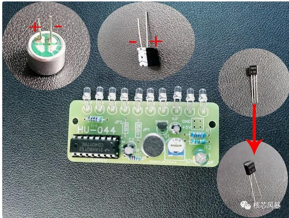
5.继续把剩余元器件焊接到PCB上，对应丝印方向，禁止插反。
