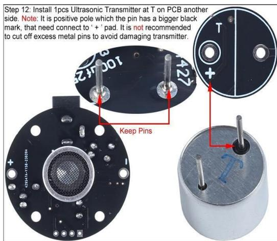
13> étape 13 Installer un émetteur ultrasonique en T sur un autre PCB plus petit. Note : C'est le pôle positif dont la broche a une marque noire plus grande, qui doit être connecté à la pastille ' + '. Il n'est pas recommandé de couper les broches métalliques excédentaires pour éviter d'endommager l'émetteur.
