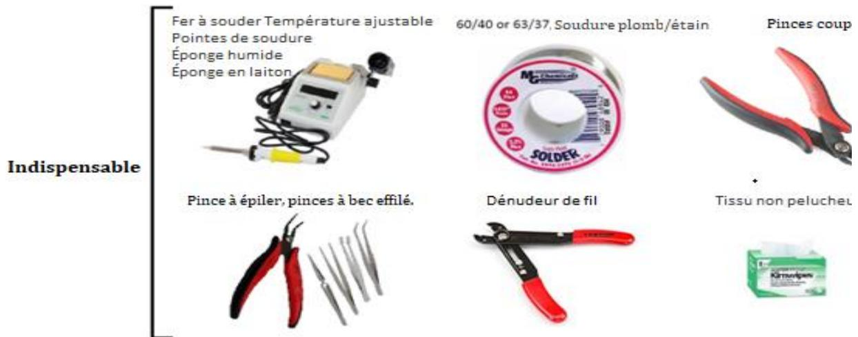
**\*Il est recommandé d'avoir en disponibilité un peu d'alcool isopropyl et une brosse fine pour nettoyer l'excédent de flux sur le circuit imprimé une fois le soudage terminé.**
