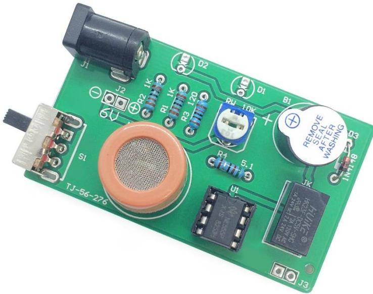
Insérez le Commutateur à glissière, la prise DC et le capteur MQ3 selon la photo et soudez-les.
