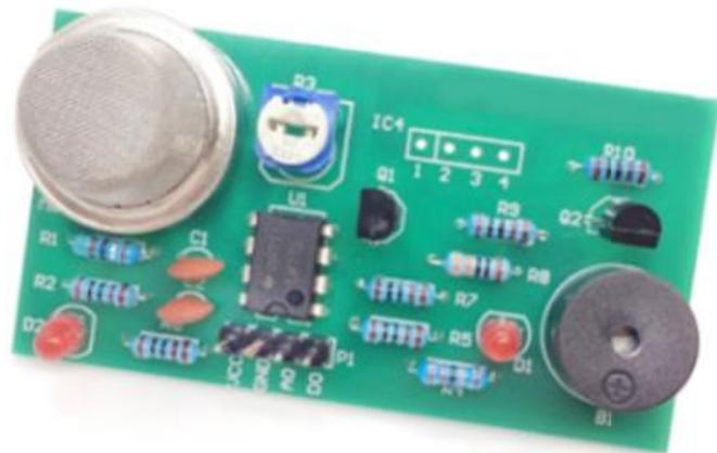
Il est recommandé de souder l'élément MQ2 avec l'étiquette orientée vers les résistances.
