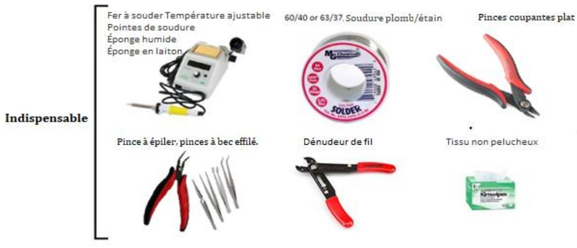
**\*Il est recommandé d'avoir en disponibilité un peu d'alcool isopropyl et une brosse fine pour nettoyer l'excédent de flux sur le circuit imprimé une fois le soudage terminé.**
