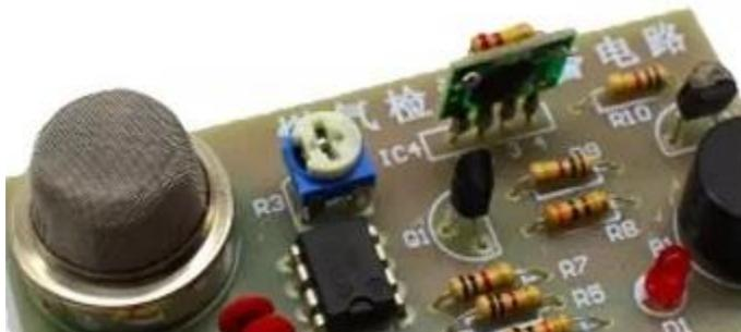
Option 2: Selon la photo, souder la carte secondaire sur le dessus de la carte principale avec les pattes des DELs (mises de côté). Vous aurez besoin d'un étau pour garder les composants en place.
