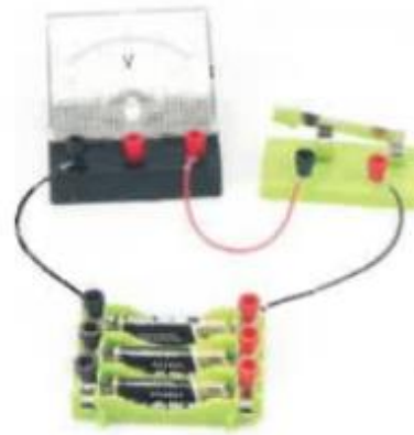
Figure 12-2 Une batterie composée de trois batteries en parallèle
