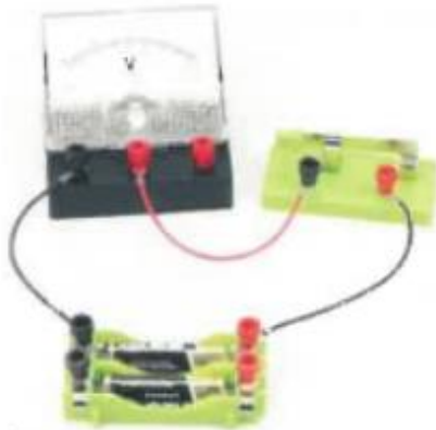
Figure 12-1 Une batterie composée de deux batteries en parallèle
