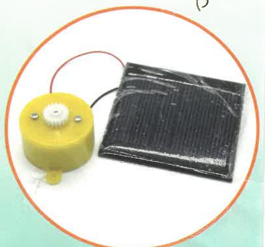
3. 用银色螺丝N将电机安装到电机座E里, 将齿轮K安装到电机轴上
