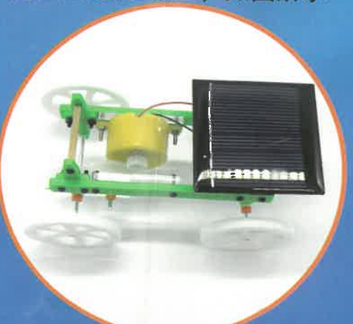
8. 将轴F安装到绿色十字条的孔里, 在所有轴上套上橙色轴套, 再将车轮安装到轴上, 如图所示
