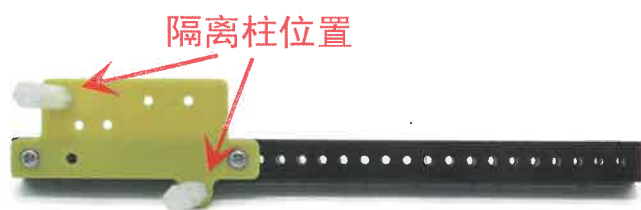
黑螺丝固定长隔离柱
