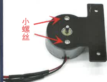
小螺丝将电机固定到固定片上
