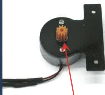
电机轴安装小齿轮
