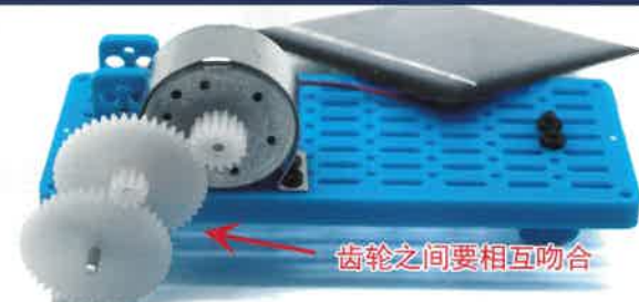
齿轮轴穿入轴架上端的孔，另一端用轴套固定
