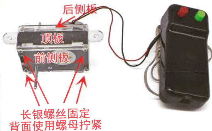
侧板与顶板如图固定在减速电机上
