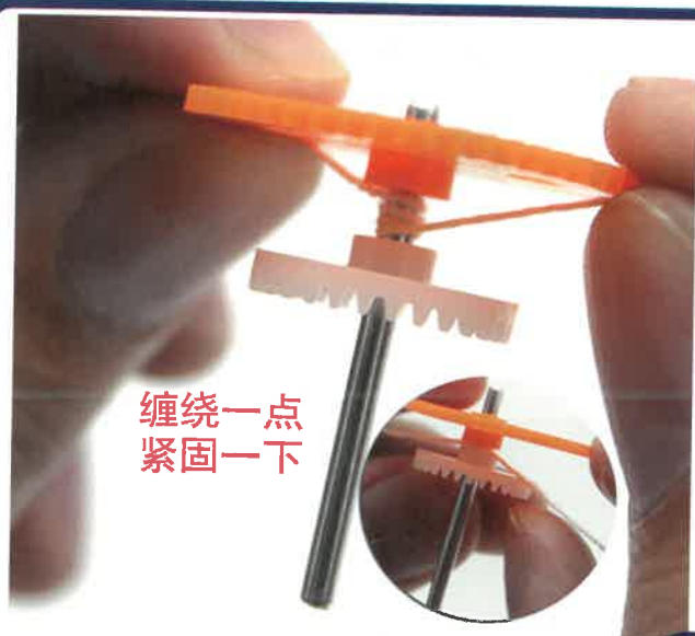
将线缠绕在黄齿轮轴的两个齿轮中间 13
