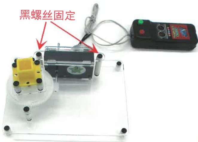
将减速电机固定在长隔离柱上 9
