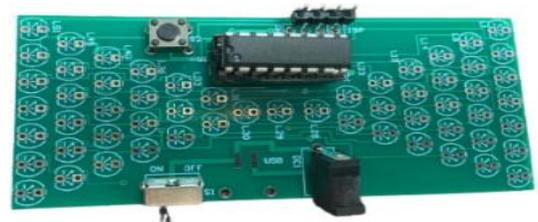
**Étape 5:** Finalement, il est temps de souder les 57 pièces DEL sur le PCB. Suivez les directives de polarité telles que présentées au début de ce manuel. La broche positive est montée selon l'image ci-bas. Attention: l'inversement de la polarité des DELs peut provoquer le brûlage de plusieurs composants.
