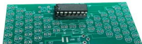
**Étape 2:** Montez le commutateur à glissoire, le bouton poussoir, aux designations S1 et S2 respectivement sur le PCB. (Aucune polarité).
