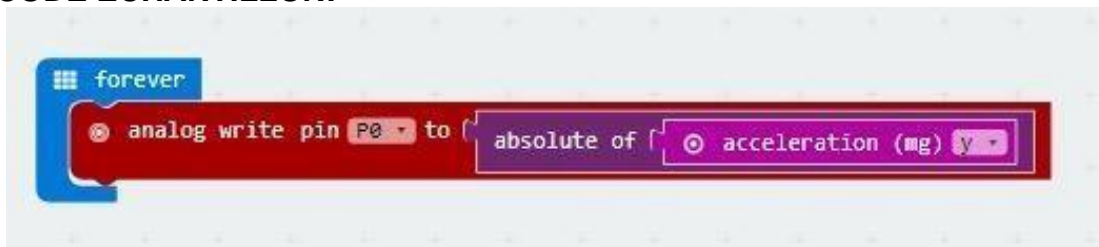
Figure 25 – Accéléromètre Contrôle de moteur
