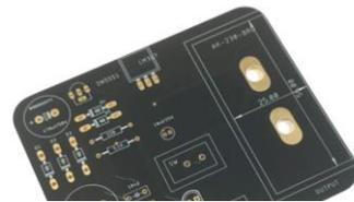
**Étape 6:** Maintenant soudez les borniers avec les trous de vissage dans le sens de direction externe.
