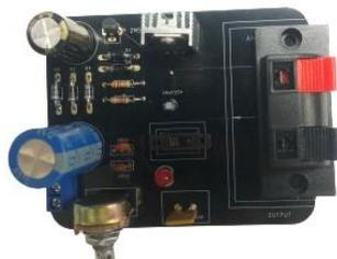
**Étape 7:** Soudez le transistor 2N5551 et la fusible à leurs désignation respective. Pour le transistor, suivez le logo sur la carte PCB. Le fusible n'a pas de polarité.
