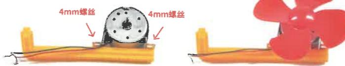
步骤3：电机安装在直角杆上，电机夹固定
