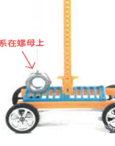
步骤10: 线的一端绑在车轮处的带轮中间,另一端绑在螺母上,线绳绕过顶部橙片里的两个带轮(如图)
