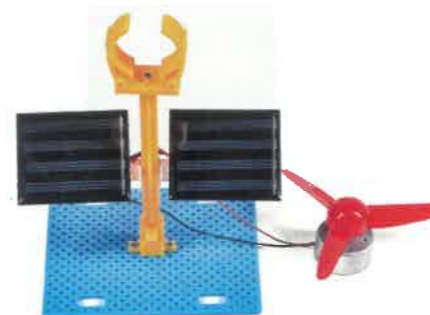
步骤7：两块太阳能板分别粘在 长靶铁上
