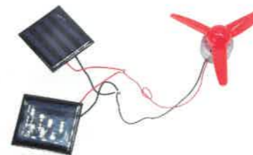
步骤6：三根红线连接，三根黑线连接 (红黑线裸露部分铜丝不能接触到)
