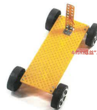
步骤4: 用两颗螺丝在底板的如图位置安装长耙铁
