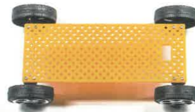
步骤3: 铁轴的两端装上四个车轮
