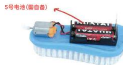
安装5号电池2节,制作完成 4
